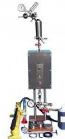
Coreflooding para evaluación de daño a la formación
