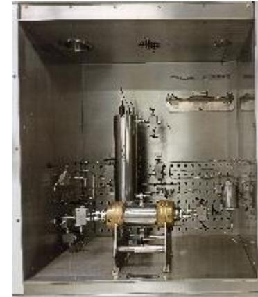
Equipos coreflooding para arreglos de núcleos de hasta 1 pie de longitud.
